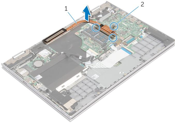
**1** dissipatore di calore
